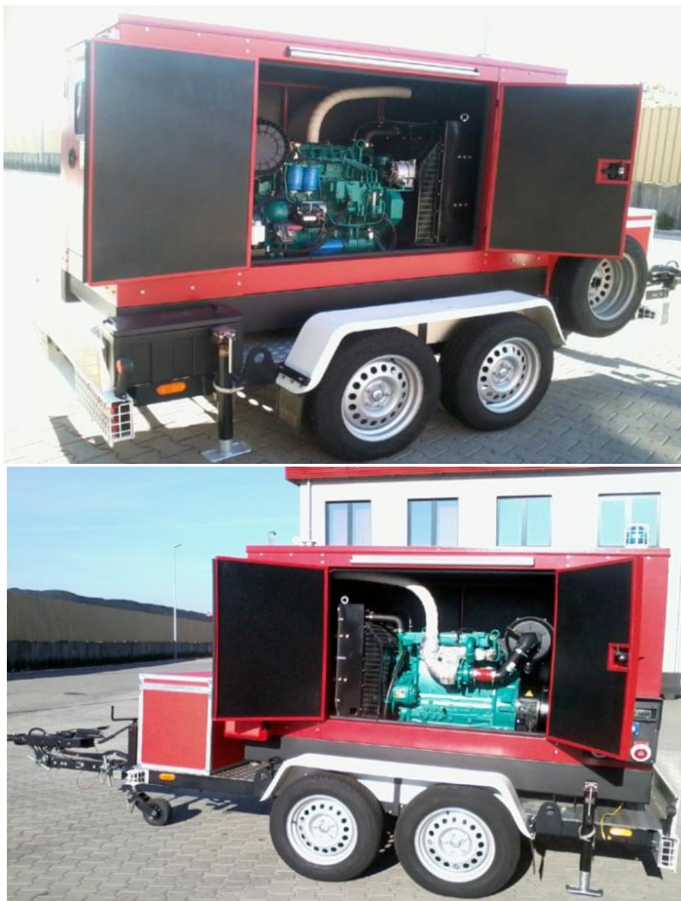
Fot. Przewoźny agregat prądowłórczy.
